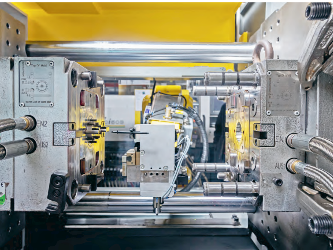
Um die Form beim Schließen zu schützen, gibt es bei der Fanuc Roboshot eine KI-Funktion, die außerdem vor Verschleiß an Form und Auswerferstiften warnt. (Bild: Fanuc)
