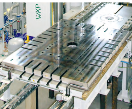
Die maximale Heizplattentemperatur ist vergleichsweise hoch ausgelegt. (Bild: Wickert)
