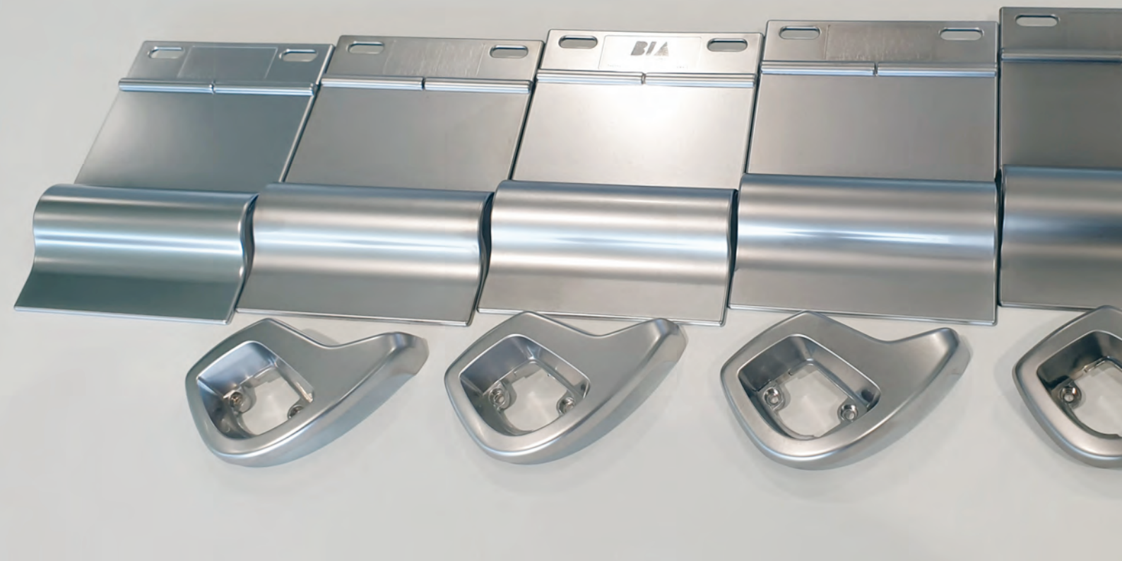
Von links: Farbvarianten von Cr(VI)- über Cr(III)-Elektrolyte, sulfatbasiert und chloridisch. (Bild: Bia)
