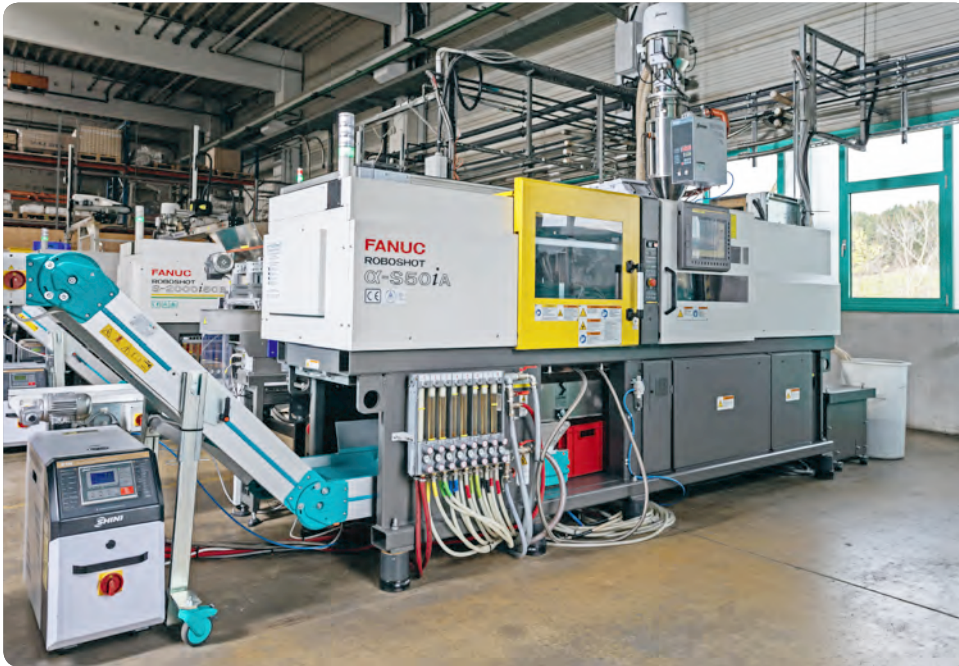
Die vollelektrische Spritzgießmaschine setzte sich in einem Maschinenvergleich vor allem aufgrund des geringeren Energiebedarfs und ihrer Präzision durch. (Bild: Fanuc)
