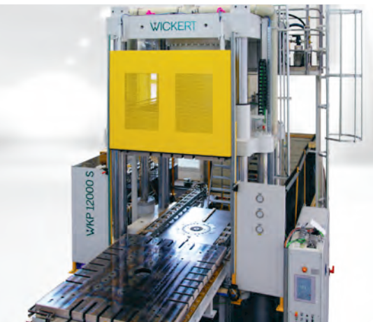
Die Oberkolbenpresse fertigt Composites mit maximal 72 Stunden Zykluszeit und 4000 Kilonewton Öffnungskraft. (Bild: Wickert)
