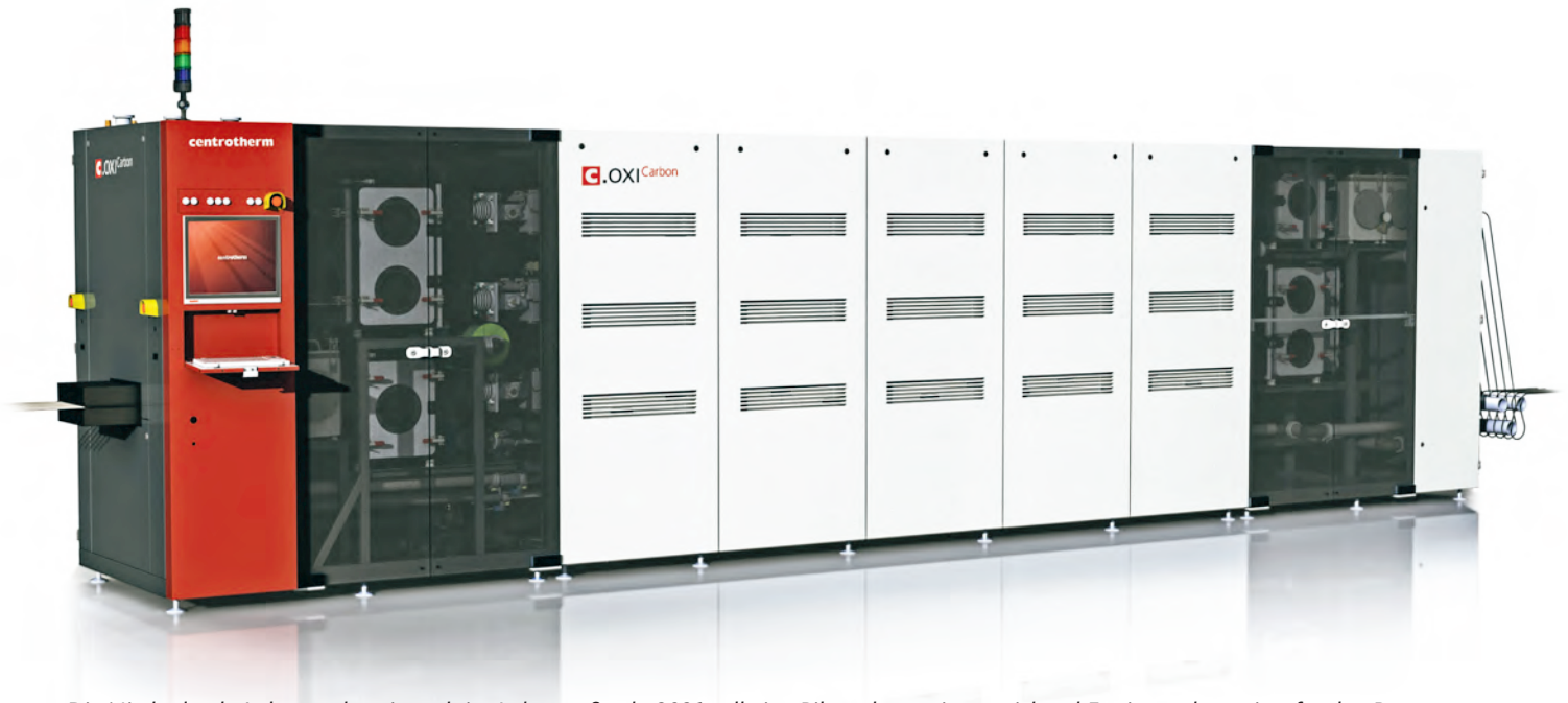
Die Niederdruck-Anlage – derzeit noch im Labormaßstab. 2021 soll eine Pilotanlage mit ausreichend Fertigungskapazität für den Bau von Prototypen und Kleinserien entstehen. (Bild: Centrotherm)
