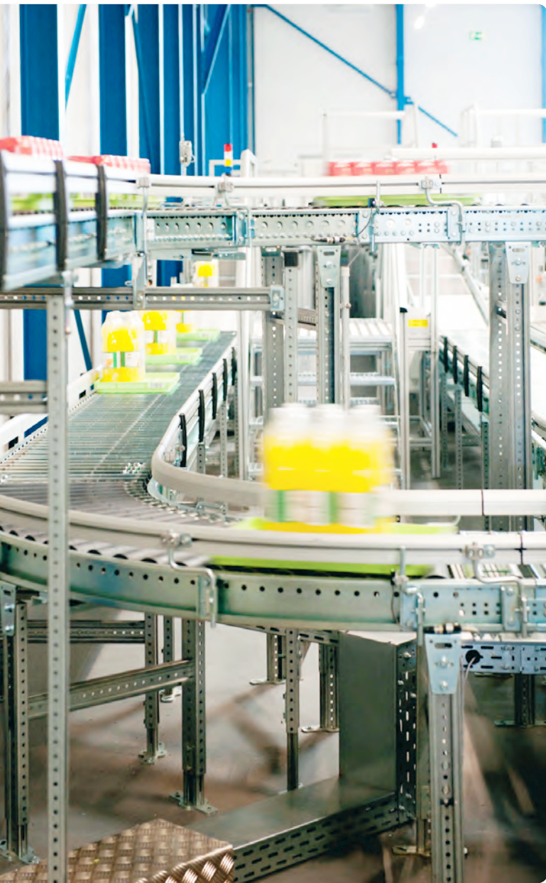
Transportlösungen wie Trays werden exakt auf die Fördertechnik zugeschnitten, auf der sie zum Einsatz kommen. (Bild: Walther)
