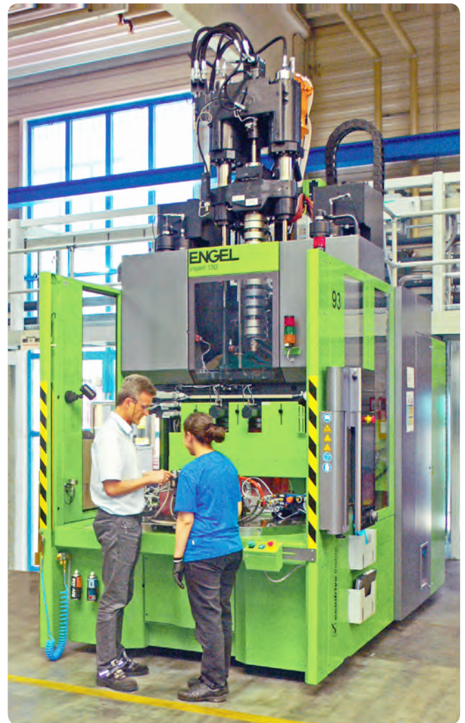
Blick in die Produktion mit der neuen Vertikal-Spritzgießmaschine mit Rundteller. (Bild: Weiss)
