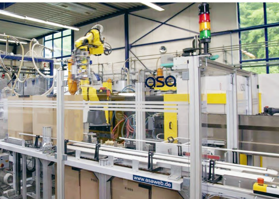
Die Produktionszelle umfasst voll elektrische Spritzgießmaschine, 6-Achs-Roboter, Prüftechnik mit Bildverarbeitung, Etikettierung und weitere Fördertechnik. (Bild: Fanuc)
