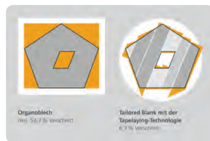
Vergleich des Verschnitts bei Verwendung von Organoblechen (links) und Tailored Blank-Technologie (rechts). (Bild: Dieffenbacher)
