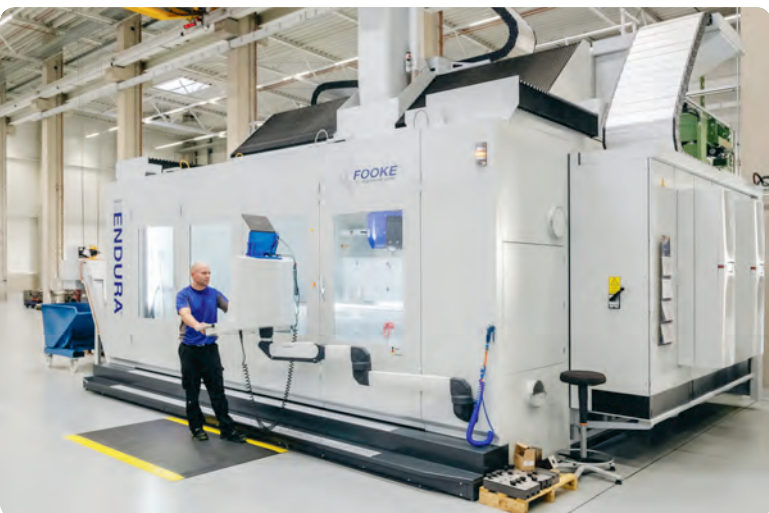
Trotz des großen Bearbeitungsraums kommt die Maschine ohne Fundamente und mit vergleichsweise geringer Stellfläche aus. (Bild: AWM, Kummerich)
