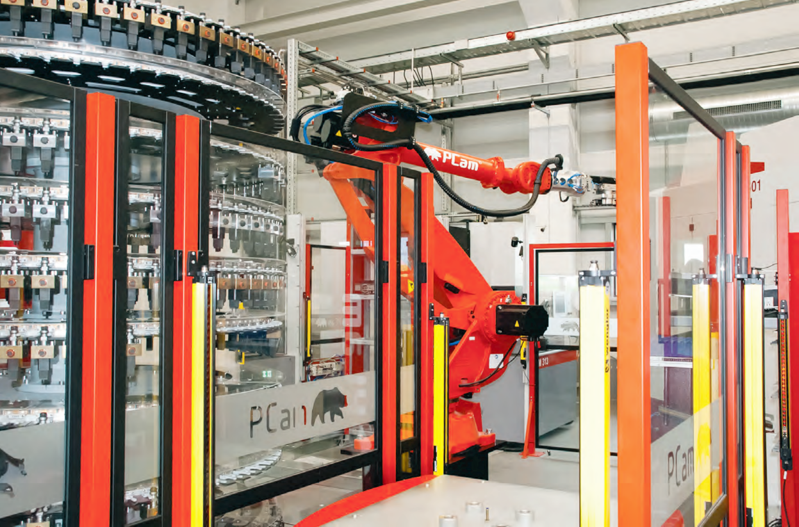
Hingucker: Die ringförmig angeordnete Fertigungszelle mit dem Knickarmroboter in der Mitte. (Bild: Mecadat)
