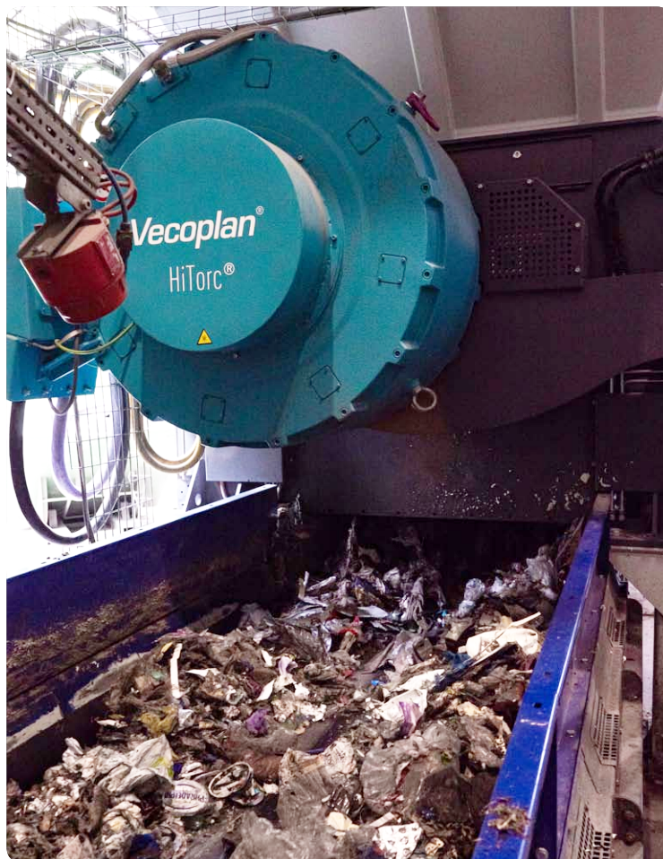
Zerkleinerer bereiten gesammelte Verpackungen aus Kunststoff, Metall und Verbundmaterialien oder auch Hausmüll effizient auf. Eine wichtige Stell-schraube ist dabei der Antrieb für den Rotor.
