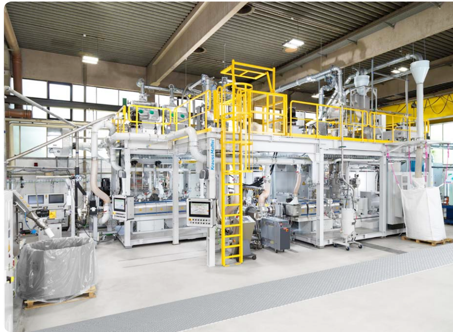
KraussMaffei-EdelweissCompounding-Technologie – Kaskadenkonzept zum Aufbereiten und Compoundieren von sortenreinen Kunststoffabfällen in einem Prozess.
