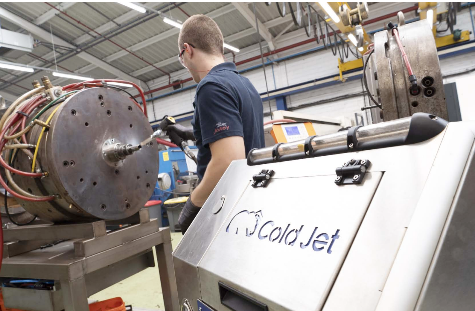
Mit dem Trockeneis-Strahl lassen sich Spritzgusswerkzeuge effizient reinigen.
