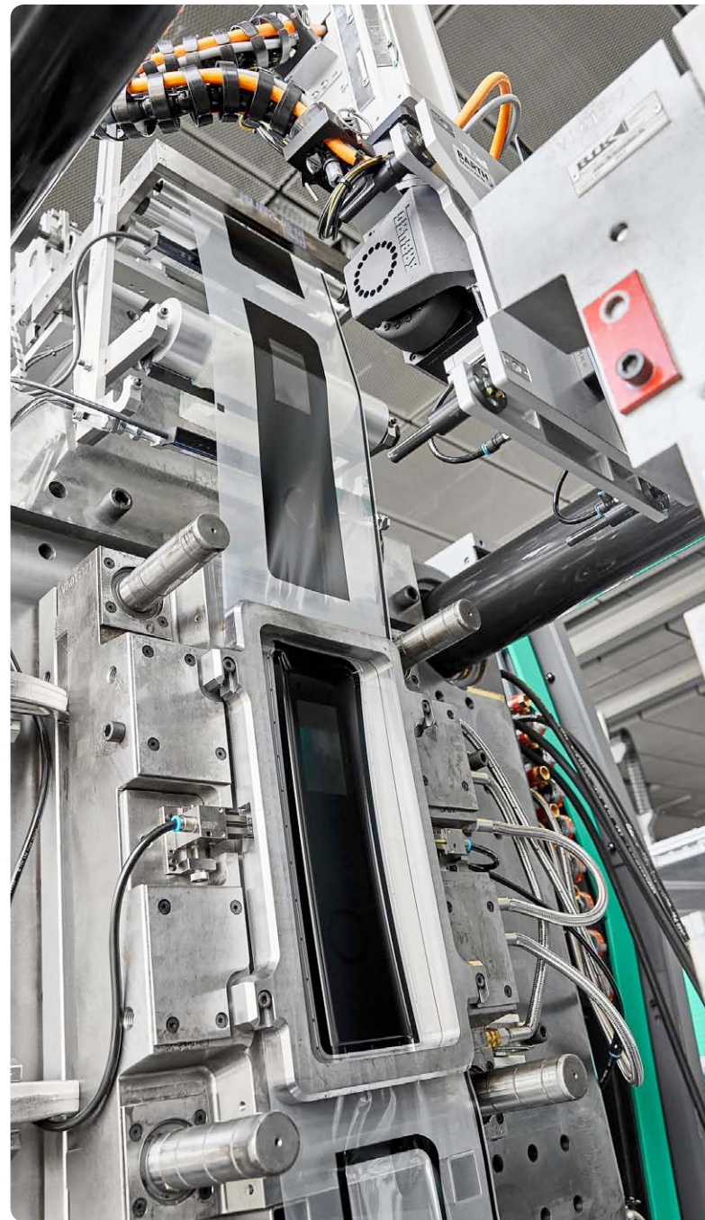
Präzise Taktung: Beim Hinterspritzen der Blende wird eine Endlos-Folie aus einem Folienvorschubgerät von Leonhard Kurz durch das Werkzeug gezogen und mittels Klemmrahmen fixiert.
