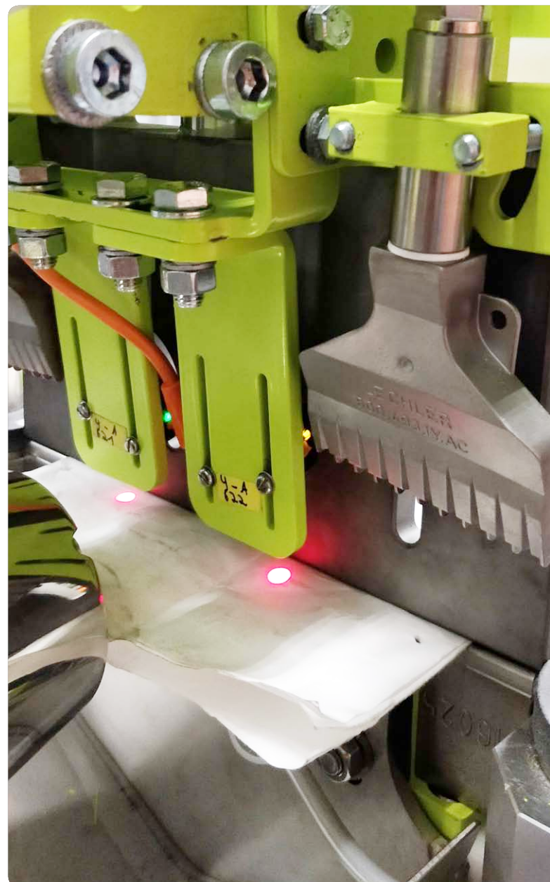
Vor dem Verschweißvorgang überprüft ValvoDetect, ob der Sack in der korrekten Position zu den Schweißsonotroden sitzt.
