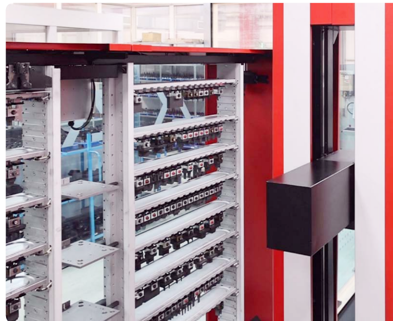
Die Automatisierungskomponenten Chameleon verbindet zwei Genius-Senkerodieranlagen unterschiedlicher Größe mit einer HSC-Fräsmaschine zur Elektrodenbearbeitung und der Messmaschine Zeiss Vista. Es stehen Plätze für 190 Elektroden und elf Werkstücke zur Verfügung.
