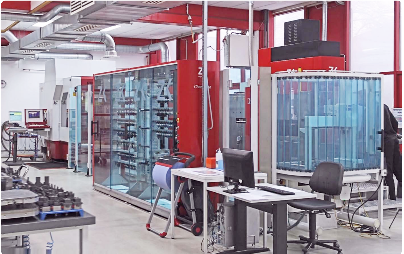
Die Automatisierung ermöglicht ein mannloses Arbeiten rund um die Uhr, auch übers Wochenende. Im Vordergrund an der Stirnseite der Anlage ist die Messmaschine Zeiss Vista positioniert.
