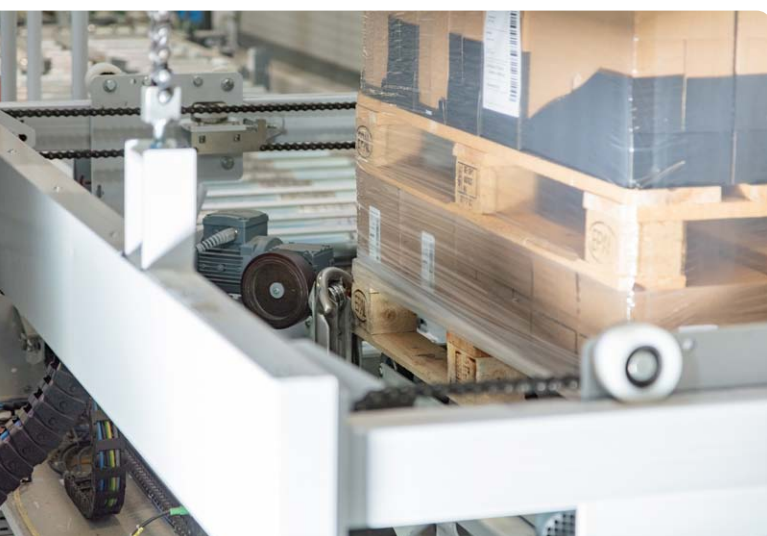
Verpackt die Anlage Paletten hochregallagerfähig, bleibt der Palettenfuß für die Kufen des Gabelstaplers frei, damit dieser die Folie nicht beschädigt. (Bild: Beumer)
