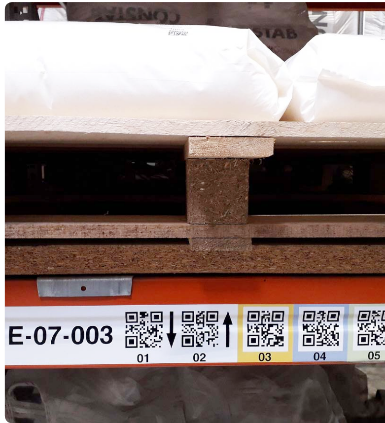
Dank mehrfarbiger Man-down-Etiketten können Kommissionierer auch höhere Ebenen bequem vom Boden aus scannen. Unterschiedliche Farbcodes für die Ebenen erleichtern ihnen die Zuordnung. (Bild: Constab)
