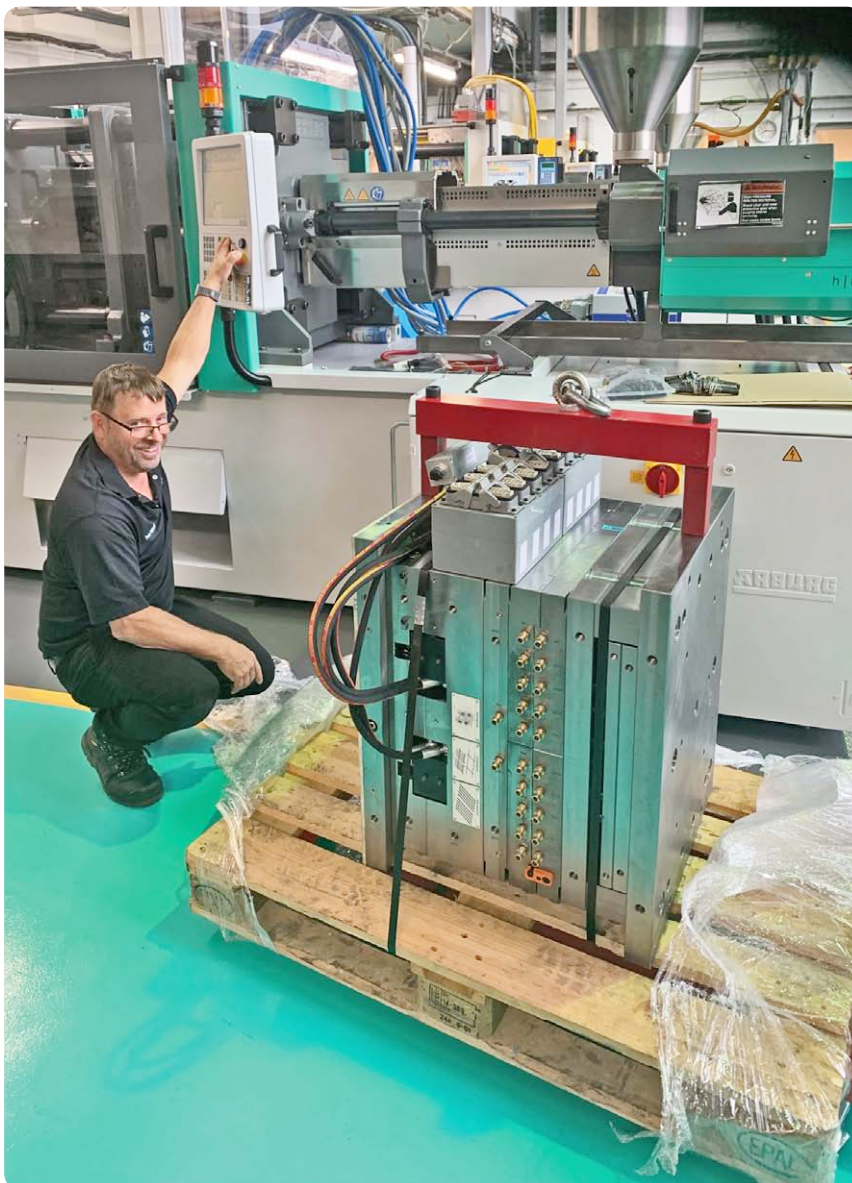
Die 32-fach-Produktionswerkzeuge für die medizintechnischen Artikel gingen nach nur zehn Wochen Entwicklungs- und Bauzeit in die Serienproduktion. (Bild: Günther)
