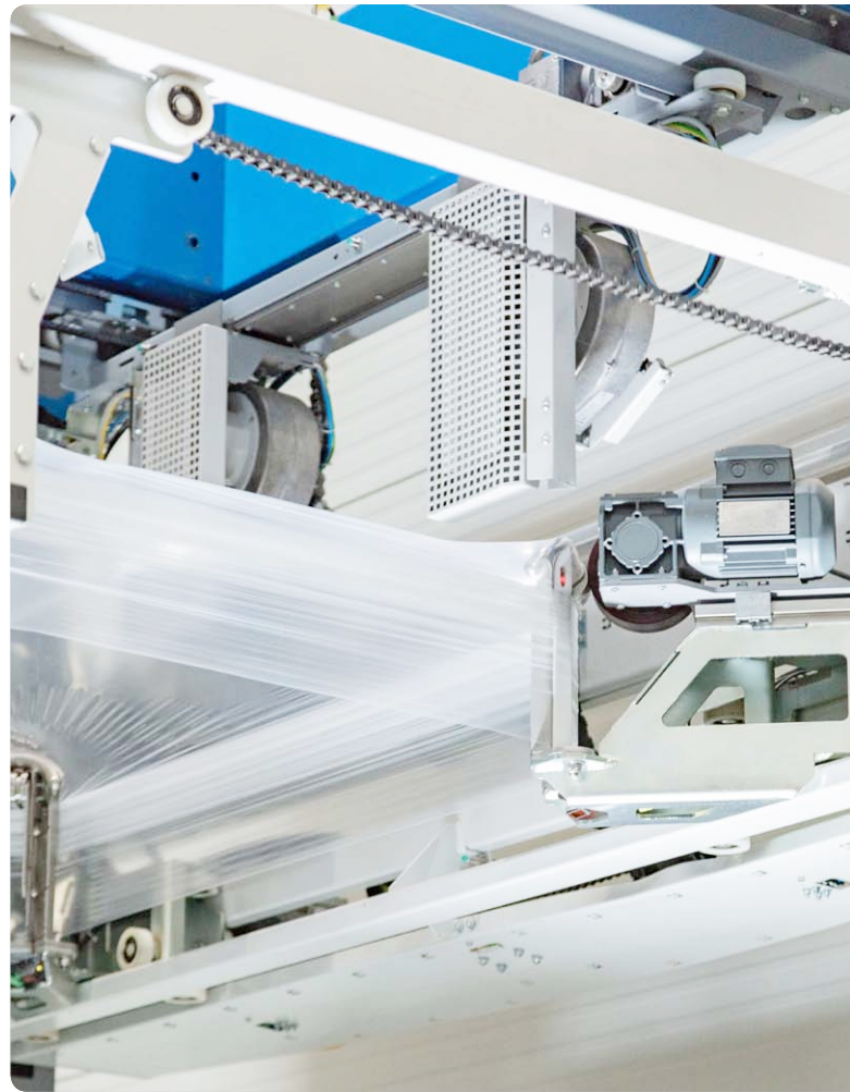
Die Paletten werden in schneller Taktung verpackt. Dabei überzieht die Maschine die Produkte mit einer hochdehnbaren Stretchhaube. (Bild: Beumer)
