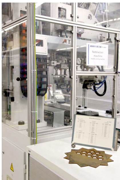
Im Musterbau bei ebm-papst wird mithilfe der Wickelanlage im Hintergrund ein erodierter Stator bewickelt.
