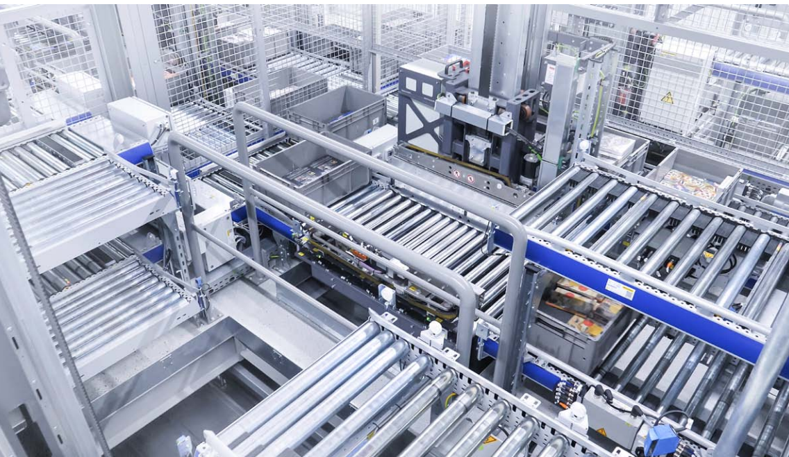
Das Shuttle-Lager ist nach der patentierten 3D-Matrix Solution von SSI Schäfer konzipiert und profitiert von einem innovativen Zusammenspiel aus Shuttle-Fahrzeugen, Liften und Behälterförderertechnik.
