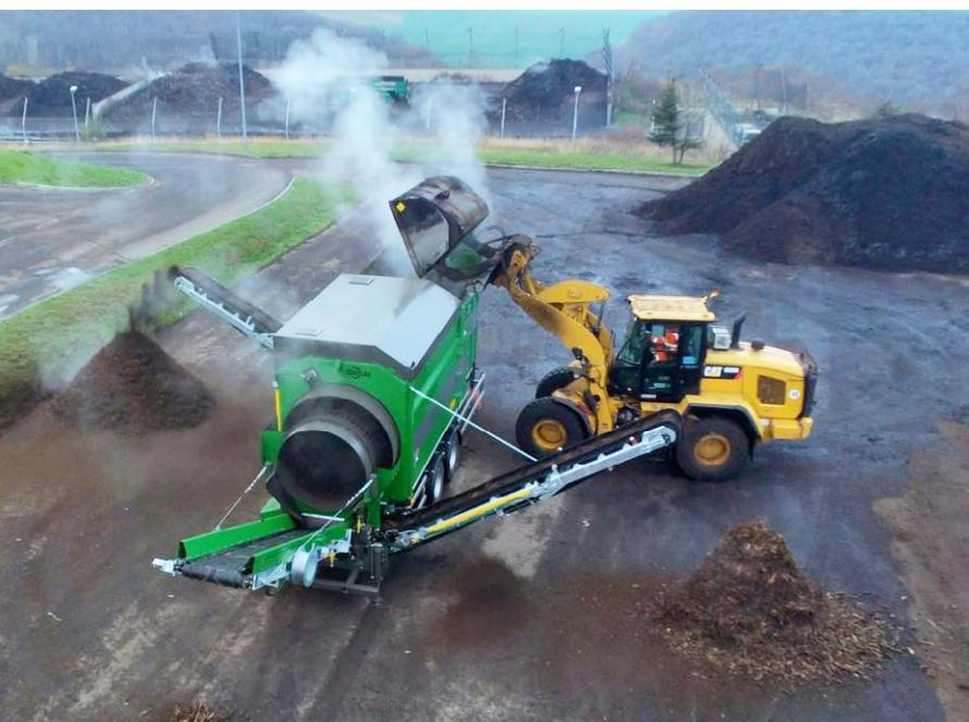
Die MS5200 verfügt über eine Siebleistung von 150 m<sup>3</sup>/h, in Nordhausen verarbeitet sie Grüngut. Foto: Zemmler
