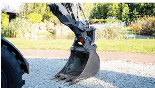
Hydraulischer Baggerdaumen für Mecalac 6MCR & 7MWR mit zweiteiligem Ausleger mit Seitenversatz.
