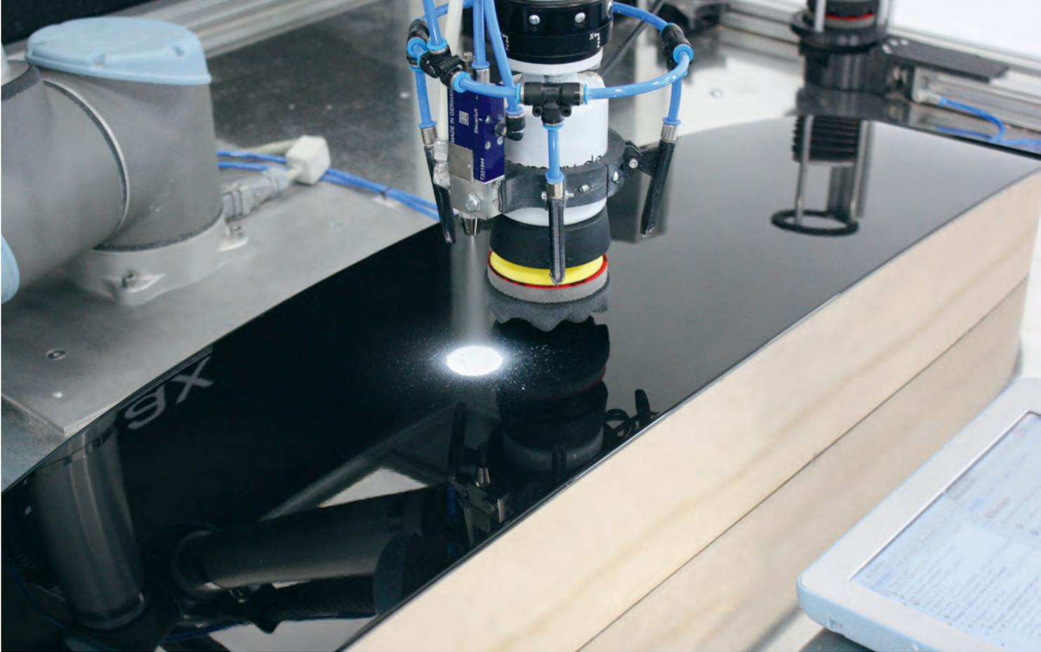
Visomax bietet Systemlösungen zum optimalen Nachbearbeiten beschichteter Oberflächen an. Im Fokus stehen vielfältige Schleif- und Polieraufgaben, für die Roboter zum Einsatz kommen. Bilder: Visomax Coating
