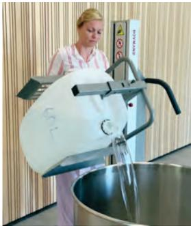
Sicheres Transportieren und Umfüllen von Schüttgut und Flüssigkeiten ermöglichen zwei neue Hebezeuge von Hovmand. Ein Eimerheber mit manueller Kippeinheit unterstützt beim Handling von Eimern und kleinen Fässern, eine mobile Abfüllhilfe erleichtert das Transportieren und Umfüllen von Kanistern. Die Werkzeuge
