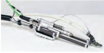
Die Deprag Schulz hat ein Leichtbauschraub-funktionsmodul entwickelt, das alle Anforderungen zur Anbindung an einen Leichtbaurob-ter erfüllt. Das Leichtbau-
