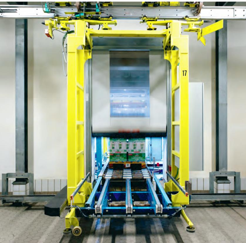
Durch die Maschinenschutz Tore EFA-SRT-MS werden in einer halben Stunde 90 Paletten vollautomatisch verladen. Bild: Efaflex
