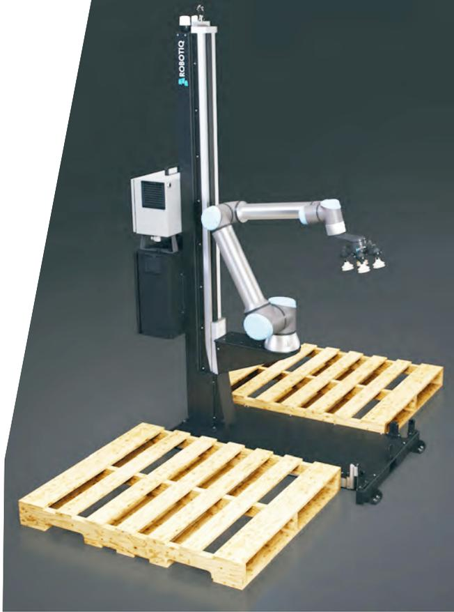
Mit Cobots gestalten sich Palettierungsaufgaben einfacher und flexibler als mit konventionellen Systemen. Bilder: Robotiq
