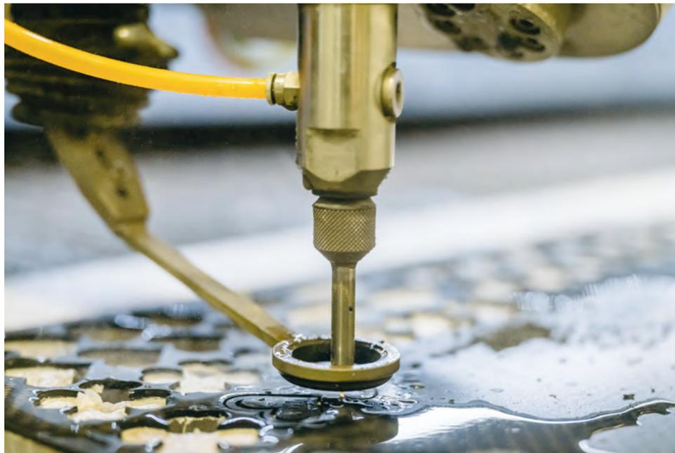
Wasserstrahlschneiden von Carbon.
