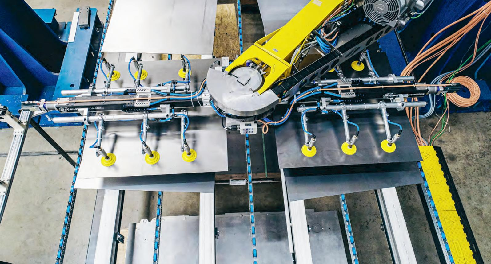
Antriebstechnik von Wittenstein kommt in allen Achsen des FeederPlus 6neo zum Einsatz.
