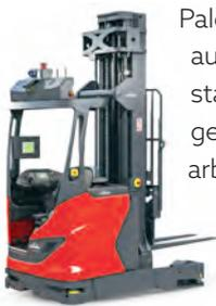
Palettenlager sind das ideale Einsatzfeld für automatisierte Geräte wie den Schubmaststapler Linde R-Matic und den Hochhubwagen Linde L-Matic HD. Die neuen Fahrzeuge arbeiten auf engem Raum und mit hoher Präzision. Mit einer Länge von 2.520 mm und einer Breite von 1.565 mm kann der R-Matic bei einer Tragfähigkeit von 1,6 t in Arbeitsgängen von bis zu 2,90 m Breite
