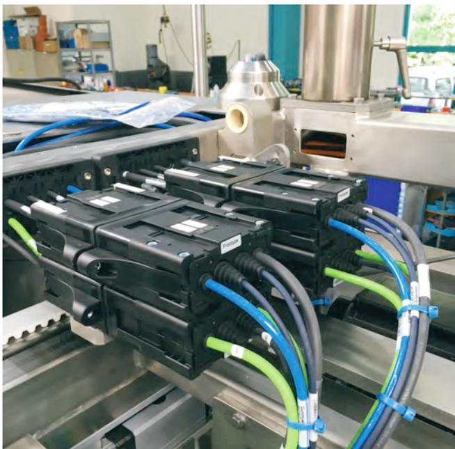
Die Brotverpackungsmaschine arbeitet mit hohen Hubzahlen in einem kompakten Bauraum. Mit Module Connect lässt sich das System aus E-Ketten und Leitungen einfach anschließen.
